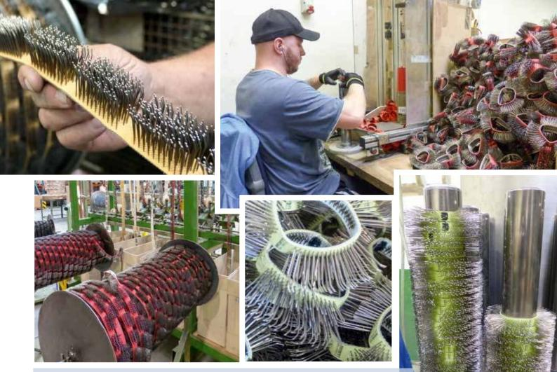
Fast eine Millionen Bürsten werden bei MONTI in Hennef produziert. Und dies für die unterschiedlichsten Einsatzbereiche – für Kfz- und Schienenfahrzeuge, Flugzeuge, Schiffe und die Industrie. Die Bürsten dienen zum schnellen und schonenden Abtrag von Farben, Lacken und Folien.
