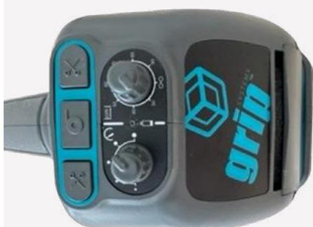
Le Grip Taper dispose de plusieurs réglages de longueur de bande et de vitesse permettant à l'utilisateur de l'ajuster selon ses besoins.
