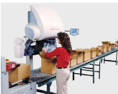
Conçu pour une utilisation en ligne. Peut être combiné à un moule sur-mesure pour former des pièces de calages. Possibilité de tubes en continu avec prédécoupe possible.
