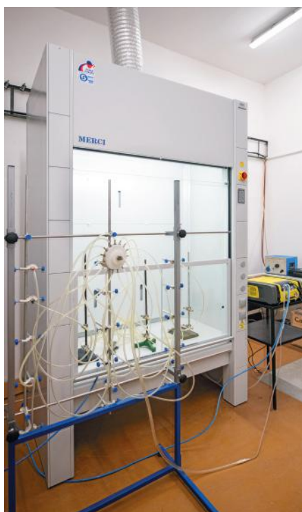
Obr. 2: Laboratorní digestoř MERCI® G při zkouškách ve zkušebně.
