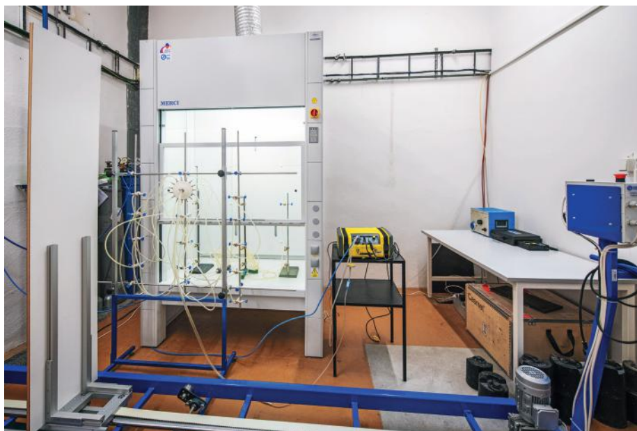
Obr. 1: Zkušební sestava pro simulaci pohybu osoby před pracovním otvorem digestoře. Pohyblivá deska vytváří rušivý vliv, který může narušit proudění u čelního otvoru a ovlivnit záchyt škodlivin
