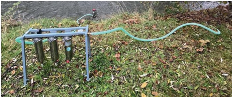
Obr. 2: Odber vzoriek mikroplastov z rieky za pomoci filtračného zariadenie obsahujúce frity s rôznou porozitou
