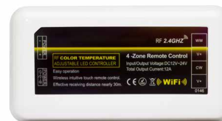
REGULADOR DE INTENSIDAD / SELECTOR DE TEMPERATURA DE COLOR BLANCO + CÁLIDO DIMMER / CCT SELECTOR
