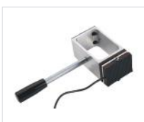
Kraftmessgerät für automatische Türen Kraftmessgerät für Türendruck von Bussen zu messen
