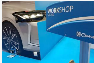
Erweiterte AFS-Funktion: Ermöglicht die Einstellung, Kalibrierung und Parametrierung von AFS-Scheinwerfern.
