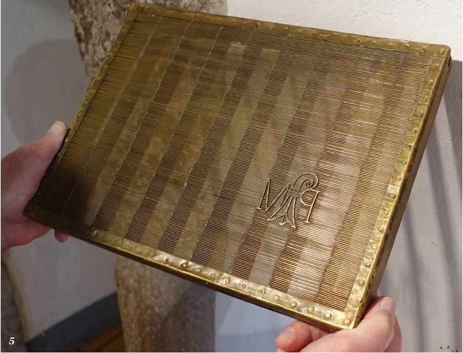
5 Mit Hilfe einer Drahtkonstruktion im Sieb erreichte man, dass sich die Papiermasse nicht gleichmäßig verteilte und so ein Wasserzeichen erzeugte.
