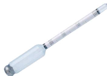
Densímetro pesa jarabes. Grados baumé. Densimeter weighs syrups. Baumé degrees.
