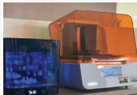
เครื่องพิมพ์สามมิติ ที่ใช้สร้างแบบจำลองลิ้นหัวใจ
