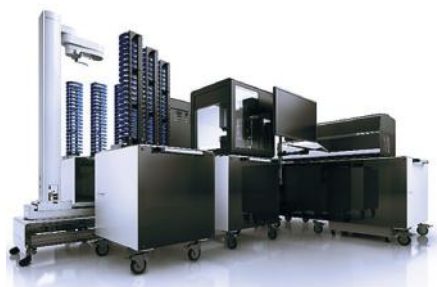
Obr. 5: Světově první autonomní robotický laboratorní systém Shimadzu s přístrojem LCMS instalovaný na Univerzitě Kobe (propojení analytické instrumentace s automatizací).
