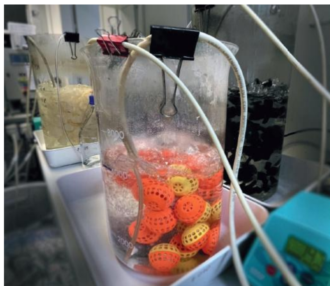
Obr. 3: Testování inovativních nosičů biomasy v laboratorních bioreaktorech.
