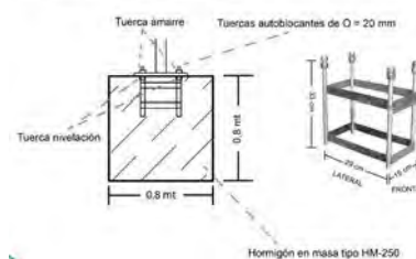
BASE DE ANCLAJE con tornillos cincados de Ø = 16 mm unidas entre sí por placas metálicas soldadas
