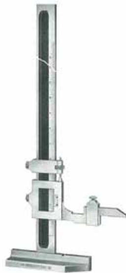
Figura 74 Medidor de altura Brown & Sharpe de 18 pulgadas (Estados Unidos) (Graduación 1 / 1000 pulg) 1924
