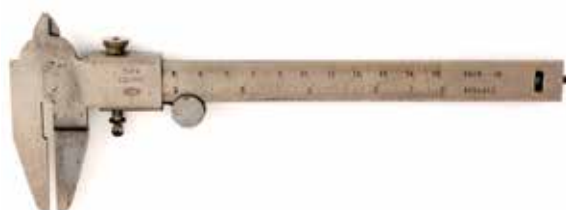
Figura 33 Calibre simplificado de Parker (Reino Unido) (Intervalo de medición: 5 pulg, 130 mm, Graduación: 1/32 pulg, 1 mm) 1920
