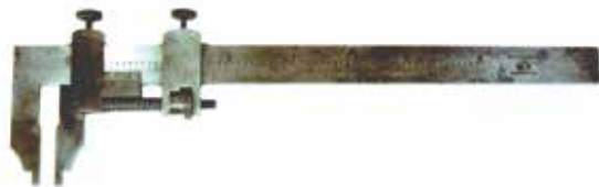
Calibrador de figura 50 de L.S. Starrett Co. (La escala principal tiene graduaciones de 1/40 de pulgada y el tornillo de desplazamiento de la punta tiene 25 graduaciones sobre su circunferencia para proporcionar una lectura mínima de 1/1000 de pulgada). Alrededor de 1900
