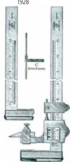
Figura 75 Medidor para profundidad de Starrett (Estados Unidos) (La parte superior izquierda de la figura es la cara posterior. Los accesorios se muestran debajo de "C", lectura mínima: 1/1000 pulg) 1924
