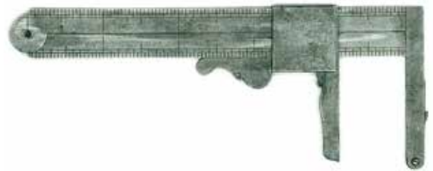
(b) Graduaciones solares en el reverso. La lectura mínima es de 5 rins, y el valor máximo de graduación es de 5 soles
