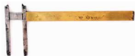
Figura 9 Calibrador deslizante tipo funda, Nogisu simplificado (en unidades de pulgada y mm) (Hecho en Francia), alrededor de 1870
