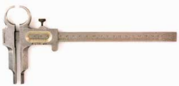
Figura 41 Calibrador a vernier con puntas redondas (Fabricado en Francia) (Intervalo de medición: 150 mm, Lectura mínima: 0.1 mm), Alrededor de 1890
