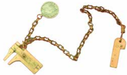
Figura 86 Calibres metálicos simplificados de pequeño tamaño (Gem Scale) Período Meiji
