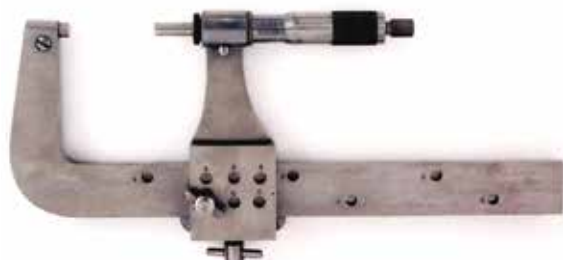
Figura 56 Calibrador con cabeza micrométrica móvil de L.S. Starrett Co. (Estados Unidos) (Intervalo de medición: 6 pulg. máximo) 1920
