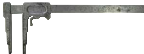
Figura 57 Calibrador Vernier para exteriores (Holanda) (Intervalo de medición: 6 pulg, 120 mm, Lectura mínima: 1/128 pulg, 0.1 mm) 1920
