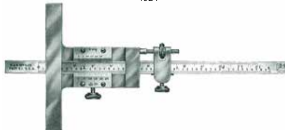
Figura 70 Medidor para profundidad de Brown & Sharpe (Estados Unidos) (Intervalo de medición: 3 1/2 pulg, 88 mm, Lectura mínima: 1/64, 1/1000 pulg, 0.02 mm) 1924
