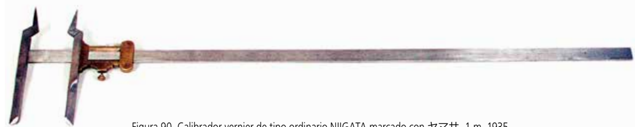
Figura 90 Calibrador vernier de tipo ordinario NIIGATA marcado con ヤマサ- 1 m, 1935
