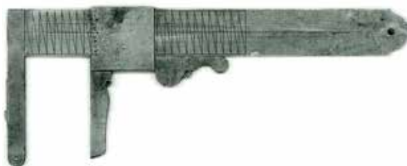
(a) Graduaciones diagonales de la superficie con una lectura mínima de 1 rin
