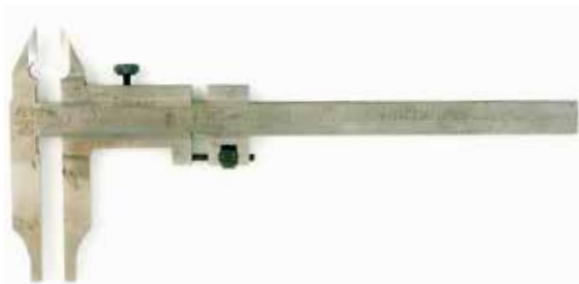
Figura 66 Calibrador a vernier con logotipo de marca de CES (Alemania) (Intervalo de medición: 5 pulg, Lectura mínima: 1/1000 pulg) 1940
