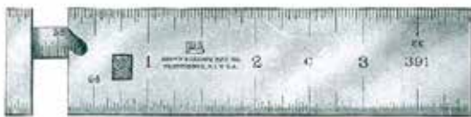
Figura 17 Calibradores simplificados fabricados por Brown & Sharpe Mfg. Co. (Estados Unidos) (Valor máximo de escala 4 pulgadas, intervalo de escala 1/32 y 1/64 pulgadas) 1924
