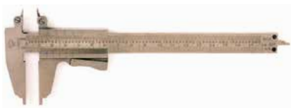
Figura 96 Calibrador vernier de Zeus (Reino Unido) (Intervalo de medición: 140 mm/5 pulg., Resolución: 0.02 mm/0.001 pulg.), 1950
