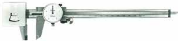
Figura 120 Calibrador de carátula de fuerza constante Mitutoyo para plástico, 1973
