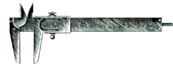
Figura 45 Calibrador Vernier multipropósito de Adolf Pfeiffer (Alemania) (Suministrado con una barra de profundidad, Calibrador denominado Columbus, Intervalo de medición: 100 mm, 4 zoll, Lectura mínima: 0.1 mm, 1/128 zoll) 1905
