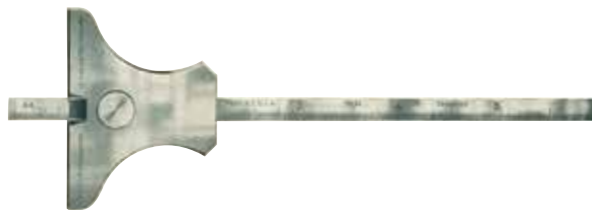
Figura 69 Medidor para profundidad de Brown & Sharpe (Estados Unidos) (Intervalo de medición: 4.5 pulgadas, graduación: 1/32 pulgadas, 1/64 pulgadas) 1924
