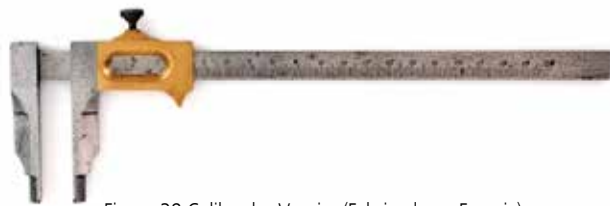
Figura 38 Calibrador Vernier (Fabricado en Francia) (Intervalo de medición: 150 mm, Lectura mínima 0.1 mm dividiendo 9 mm en 10), alrededor de 1890
