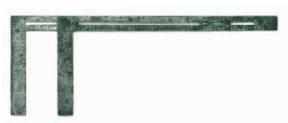
Figura 80 Calibradores simplificados de latón, era Edo tardía
