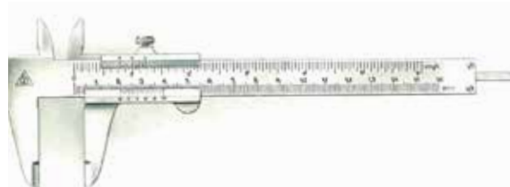
Figura 62 Calibrador Vernier de bolsillo de Carl Mahr Esslingen a. N. (Alemania) (Intervalo de medición: 120 mm, 5 pulg, Lectura mínima: 0,05 mm, 1/128 pulg) 1931
