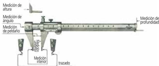
Figura 113 Calibrador Vernier Universal Mitutoyo, 1970
