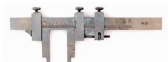
Figura 25 Calibrador deslizante de L.S. Starret Co. (Estados Unidos) (Intervalo de medición: 3~6 in, Graduación: 1/64, 1/100 pulg) 1890, 1927
