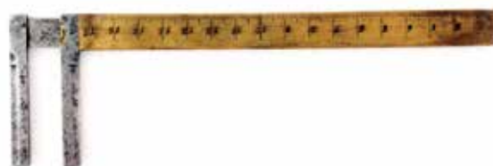
Figura 8 Calibrador deslizante tipo funda, Nogisu simplificado (en unidades de pulgada y pouce) (Hecho en Francia), alrededor de 1840
