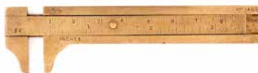
Figura 34 Calibrador simplificado de Rabone and Sons (Reino Unido) (Intervalo de medición: 3 pulg, 80 mm, Graduación: 1/32 pulg, 1 mm) 1920
