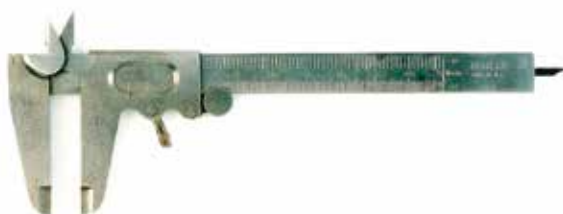
Figura 31 Calibrador simplificado de Dunlop Co. (Estados Unidos) (Intervalo de medición: 5 pulg, Graduación: 1/16 y 1/32 pulg) 1920
