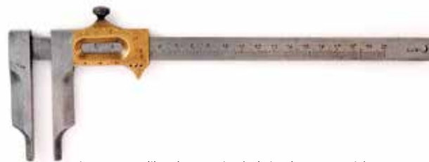
Figura 39 Calibrador Vernier (Fabricado en Francia) (Intervalo de medición: 150 mm, Lectura mínima 0.05 mm dividiendo 19 mm en 20), alrededor de 1890
