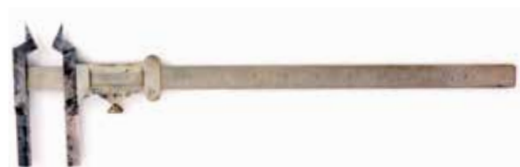
Figura 88 Calibrador vernier de tipo ordinario marcado con Tokyo(㊦) (japonés), 1935
