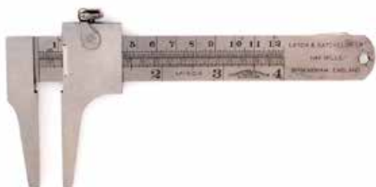
Figura 32 Calibrador simplificado de Chesterman Sheffield (Reino Unido) (Intervalo de medición: 4 pulg, 120 mm, Graduación: 1/32 pulg, 0.5 mm) 1900
