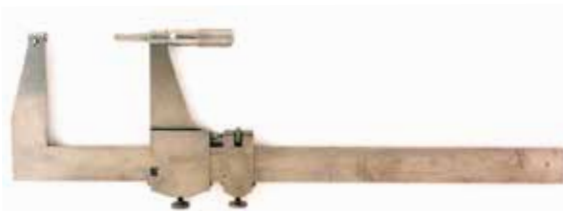
Figura 55 Calibrador con cabeza micrométrica de Brown & Sharpe Mfg. Co. (Estados Unidos) (Intervalo de medición: 12 pulg. máximo) 1920
