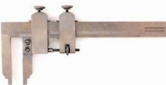
Figura 23 Calibrador simplificado de Brown & Sharpe Mfg. Co. (Estados Unidos) (Rango de medición: 3 pulgadas, graduación: 1/32 pulgadas) 1910, mismo tipo en 1924
