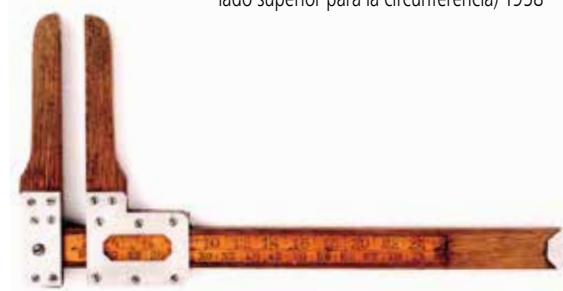
Figura 29 Calibrador deslizante de madera (Fabricado en Francia. Graduación superior para diámetro: 1 cm con escala máxima de 25 cm, Graduación inferior para circunferencia: 2.5 cm con escala máxima de 80 cm) 1930
