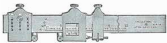
Figura 54 Calibrador con cola de milano de L.S. Starrett Co. (Estados Unidos) (Ángulo de cola de milano: 45, 55, 60°, Intervalo de medición: 0~12 pulg, Lectura mínima: 1/1000 pulg) 1927
