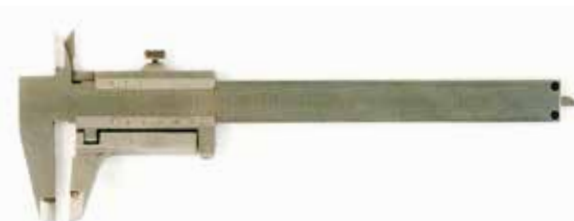
Figura 59 Calibrador de punta giratoria de Helios Co. (Alemania) (Intervalo de medición: 5 pulgadas, lectura mínima: 1/128 pulgadas, 1/1000 pulgadas) 1940
