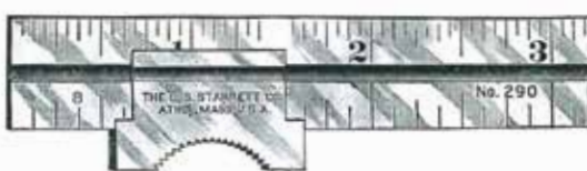
Figura 19 Regla con deslizador de pulgar fabricada por L. S. Starrett Company (Estados Unidos) (Valor máximo de escala 6 pulgadas, intervalo de escala 1/8, 1/16 pulgadas) 1927
