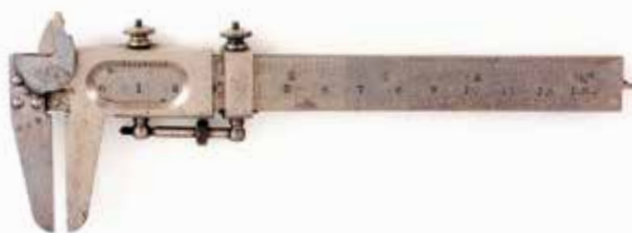
Figura 42 Calibrador Vernier multipropósito de Rawco Co. (Reino Unido) (Provisto con una barra de profundidad, Escala máxima en el borde inferior: 120 mm, Escala superior: 5 pulg, Intervalo de medición: 100 mm, 4 pulg, Lectura mínima: 0,1 mm, 1/128 pulg (dividiendo 7 graduaciones en 1/16 de pulgada) en 8) 1900
