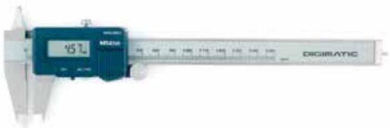
Figura 139 Calibrador digital Mitutoyo con graduaciones de escala principal, 1987
