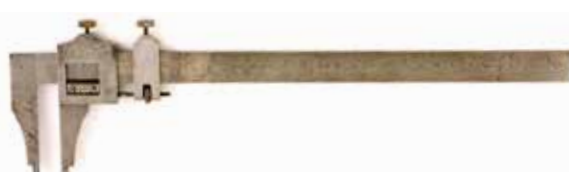
Figura 94 Calibrador Vernier tipo Brown & Sharpe, Okada Yasukichi Shoten (Japón), 1944
