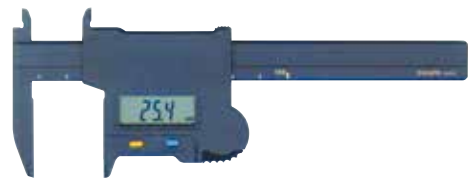
Figura 142 Calibrador digital de uso doméstico Mitutoyo Mini (DIGIPA Mini), 1995
