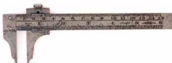
Figura 36 Calibrador simplificado de Sheffield (Reino Unido) (Intervalo de medición: 5 pulg, 13 cm, Graduación: 1/32 pulg, 0.5 mm) 1950
