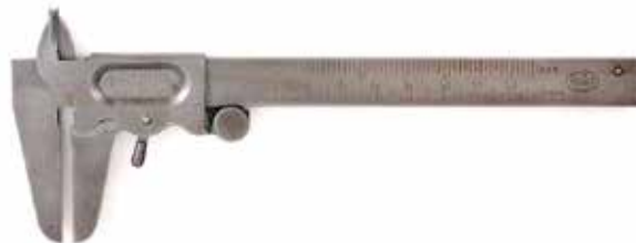
Figura 58 Calibrador Vernier de Helios Co. (Alemania) (Intervalo de medición: 120 mm, 4 pulg, Lectura mínima: 0,1 mm, 1/128 pulgadas,) 1920
