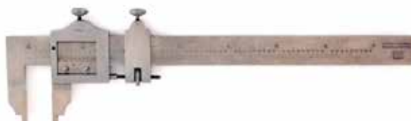
Figura 48 Vernier Caliper de Brown & Sharpe Mfg. Co. (Intervalo de medición: 5 pulg, Lectura mínima: 0.001 pulg) 1910
