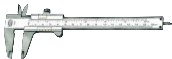
Figura 64 Calibrador Vernier de Mauser-Messzeug GmbH (Alemania) 1940
