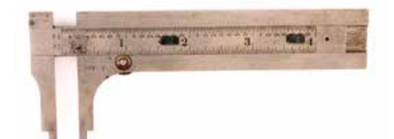
Figura 27 Calibrador de bolsillo simplificado de L.S. Starret Co. (Estados Unidos) (Intervalo de medición: 4 pulg, Graduación inferior: 1/32 pulg, Graduación superior para circunferencia: 1/64 pulg) 1960
