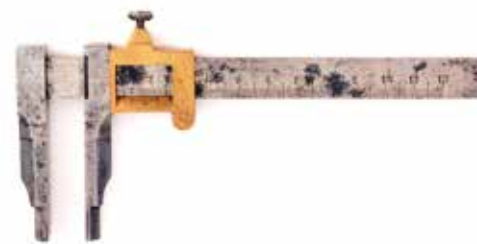
Figura 40 Calibrador Vernier (Fabricado en Francia) (Intervalo de medición: 100 mm, Lectura mínima: 0.1 mm), Alrededor de 1890
