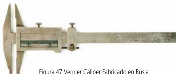
Figura 47 Vernier Caliper Fabricado en Rusia Intervalo de medición: 150 mm, Lectura mínima: 0.05 mm (dividiendo 39 mm en 20) 1910
