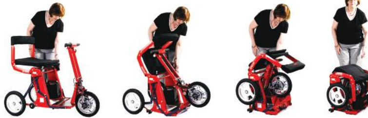
Pliage automatique sur simple pression d'un bouton sur le scooter
