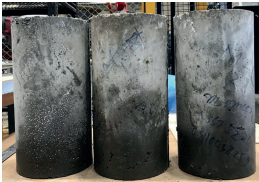
RMIT-teamets nye støbetechnik genererer strukturel letbeton fra brugt dækgummi. Foto: Mohammad Islam, RMIT.
