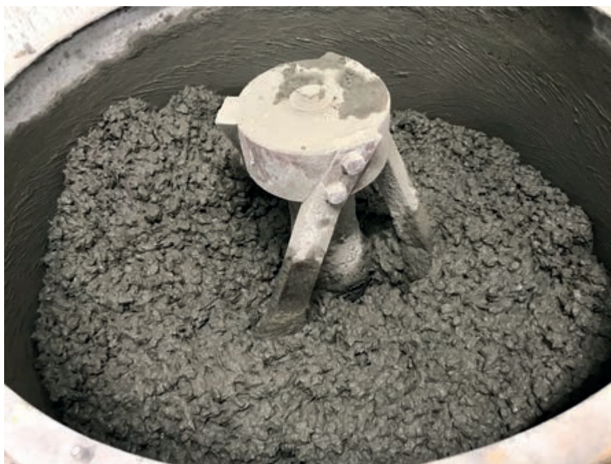
RMIT-teamets nye støbetechnik genererer strukturel letbeton fra brugt dækgummi. Foto: Mohammad Islam, RMIT.
