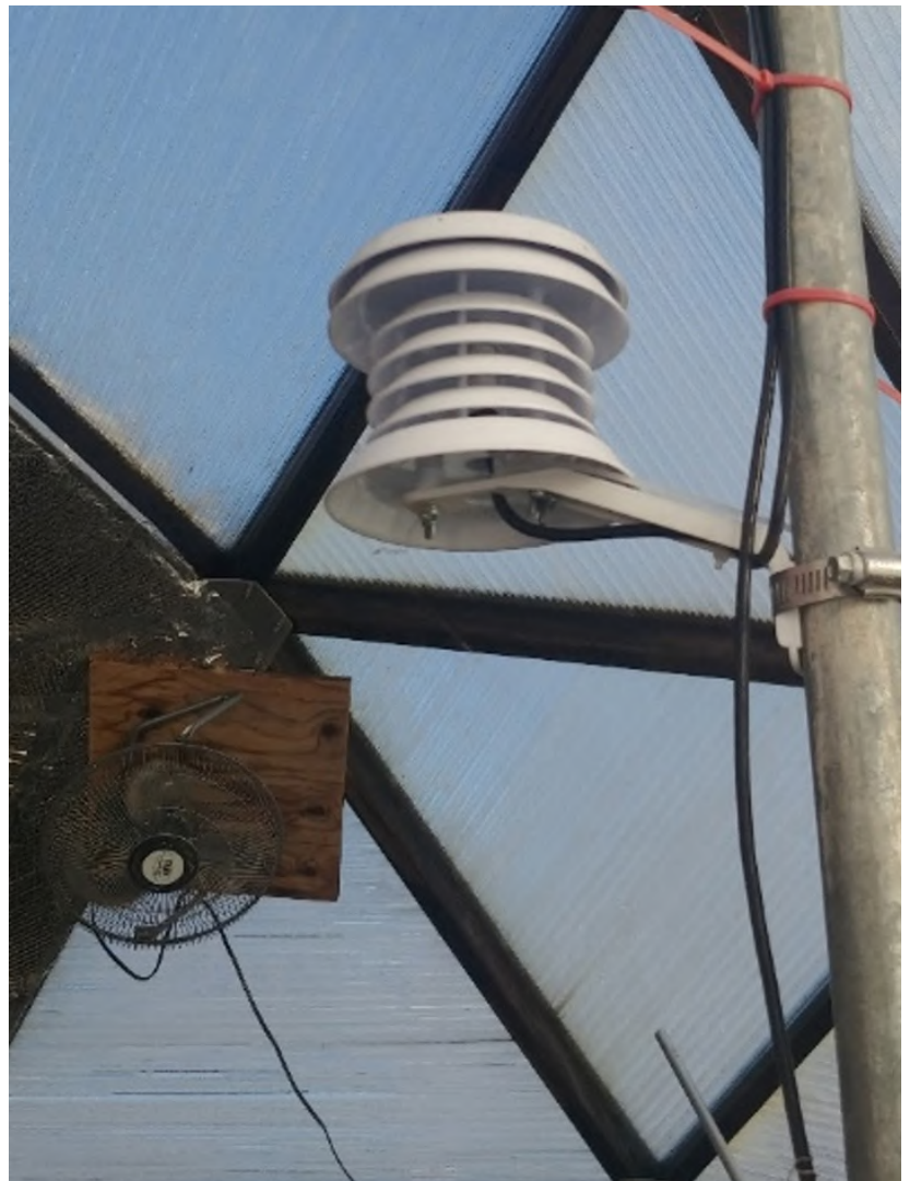
Sonde utilisée afin de mesurer la température et l'humidité de la serre. Photo : @TSR
