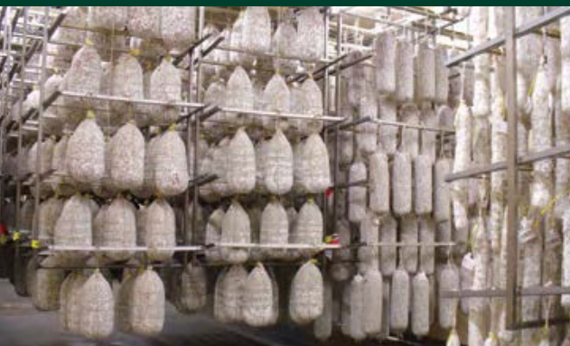
Una cella per la stagionatura dei salami
