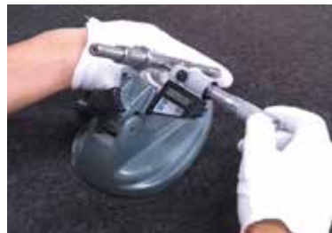
La medición del diámetro con un micrómetro no puede detectar una condición lobular de número impar y la resolución es marginal.
