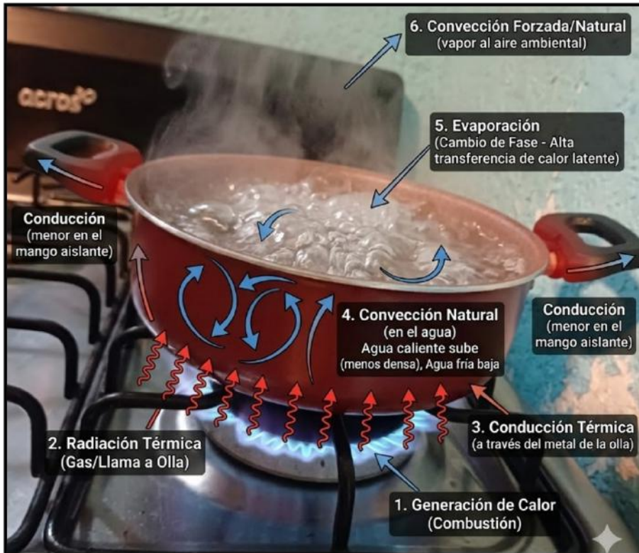
Fig. 2 La combustión transfiere energía a la base de la olla por radiación, convección, conducción y contacto.
