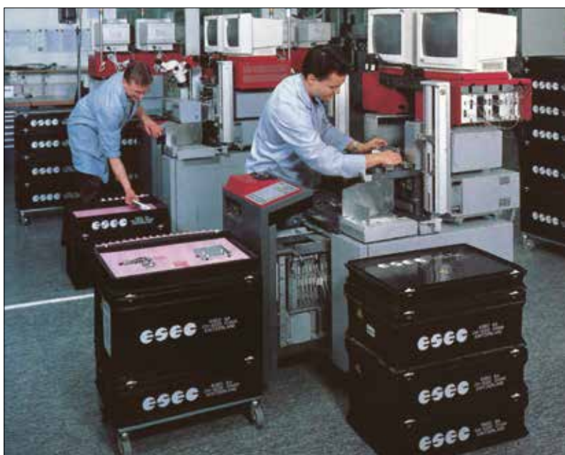
In einer ESD-sicheren Arbeitsumgebung sind nicht nur die Behälter, sondern auch der Boden, die Schuhe, die Arbeitsplätze und Wagen leitfähig!
