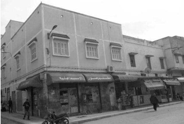
Etat existant: La plupart des portes sont façonnées en vantaux métalliques ouvrant à l'extérieur et empiètent totalement sur le trottoir. Elles sont exploitées aussi comme supports aux différents étalages commerciaux.
