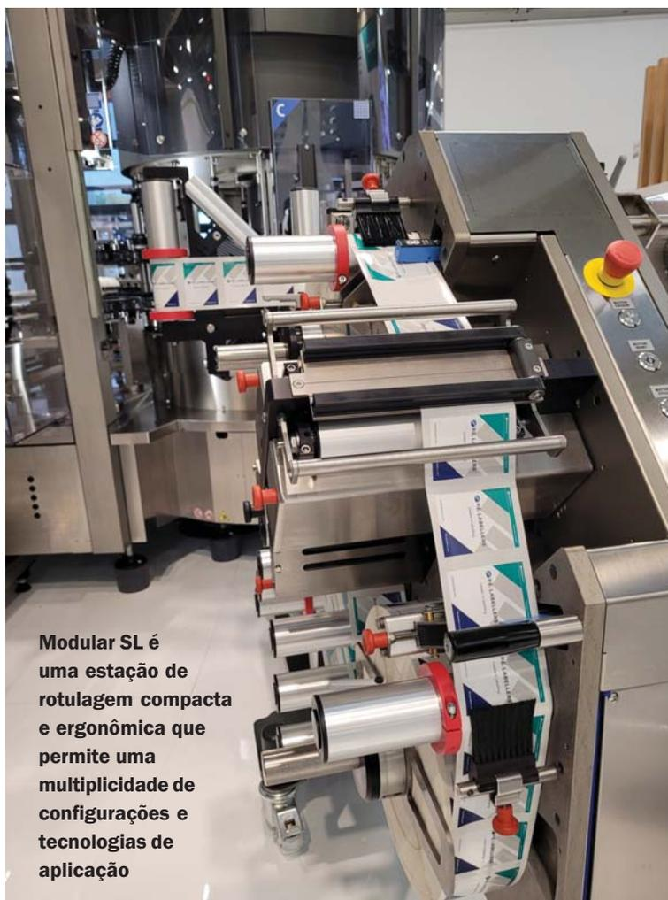
**Modular SL é uma estação de rotulagem compacta e ergonômica que permite uma multiplicidade de configurações e tecnologias de aplicação**
