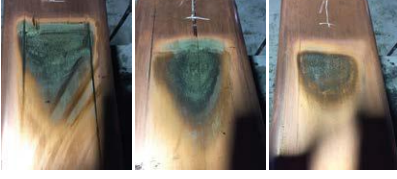
Şekil 4. Menü bölgesinde meydana gelen siyah birikintiler
