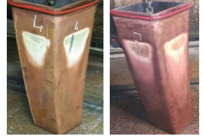
Şekil 3a ve 3b. Kalıp yüzeyinde, menus bölgesindeki farklı renkte ve geometride oluşan çöküntüler
