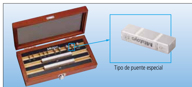
Patrón de calibración para un comparador de bloques patrón Código No. 516-145-E2
