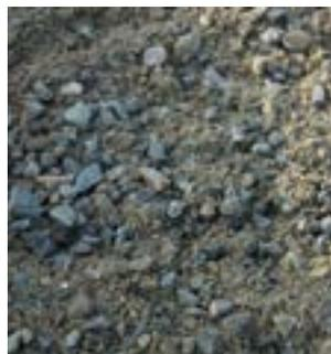
Récupération de déchets béton en circuit court dans les Hauts-de-France pour la réalisation du gravier recyclé
