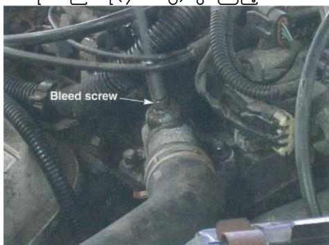
ပုံ(၄၈-၁၅) Cooling System Bleeding screw or bleed valve ကို အသုံးပြုပြီး ကူးလန်တွေအသစ်ဖြည့်ရာတွင် လေချုပ်ပေးရပါမည်။
