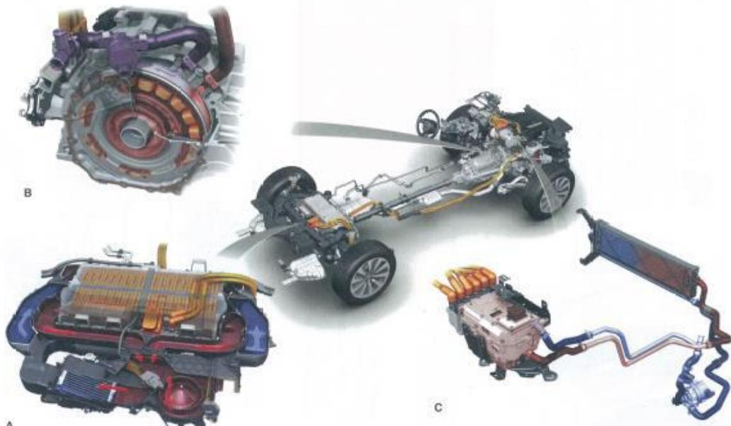
ဗု(၄၇-၂၉) လျှပ်စစ်စနစ်တွေကို အအေးပေးရန် အရည်အအေးပေးစနစ်ကို အသုံးပြုပါသည်။ A- HV battery တွေကို အအေးပေးရန် လေနှင့်ကူးလန်နှစ်မျိုးစလုံးကို အသုံးပြုပါသည်။ B- မော်တာ-ဂျင်နရေတာကို အရည်အအေးပေးစနစ်ကို အသုံးပြုပါသည်။ C- High-power HV power control modules တွေမှာ ကိုယ်ပိုင်ရေဒီရေတာပါရှိပြီး အအေးခံပါသည်။
