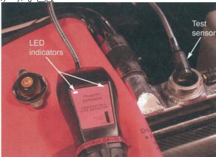
ပုံ(၄၈-၄) Exhaust gas analyser. Test Sensor ကို ရေတိုင်ကိုအတွင်းထည့်ကာ ကားကို စက်နှီးကာ အင်ဂျင်လည်ပတ်နှစ်းကို တင်ပါ။ LED indicator မှာ ကူးလန်ထဲကို အိတ်အောက်တွေတွေ ရောက်မရောက် ပြသပေးပါသည်။
