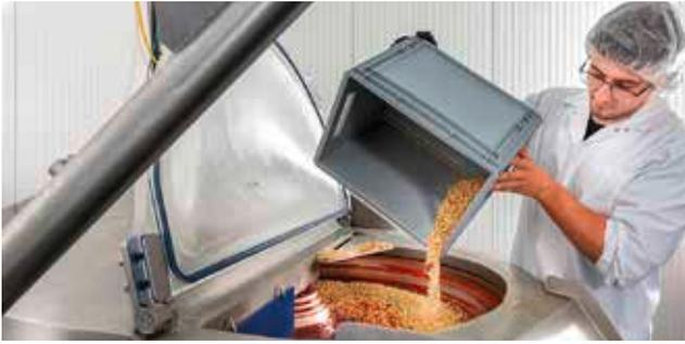
Die Vakuumkutter von **K+G Wetter** eignen sich auch zur Herstellung veganer und vegetarischer Produkte. Der Kühleffekt des Vakuums schützt empfindliche Pflanzenproteine vor Denaturierung. Durch stärkeres Quellen bilden sich längere Eiweißketten. Die Produkte sind intensiv im Geschmack und in ihrer Konsistenz verbessert. Durch den geringeren Sauerstoffanteil sind die Lebensmittel auch ohne zusätzliche Konservierung lange haltbar.
