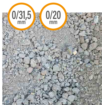
Grave Béton Recyclé
