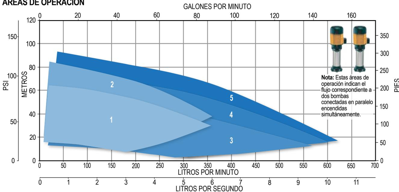
**Nota:** Estas áreas de operación indican el flujo correspondiente a dos bombas conectadas en paralelo encendidas simultáneamente.
