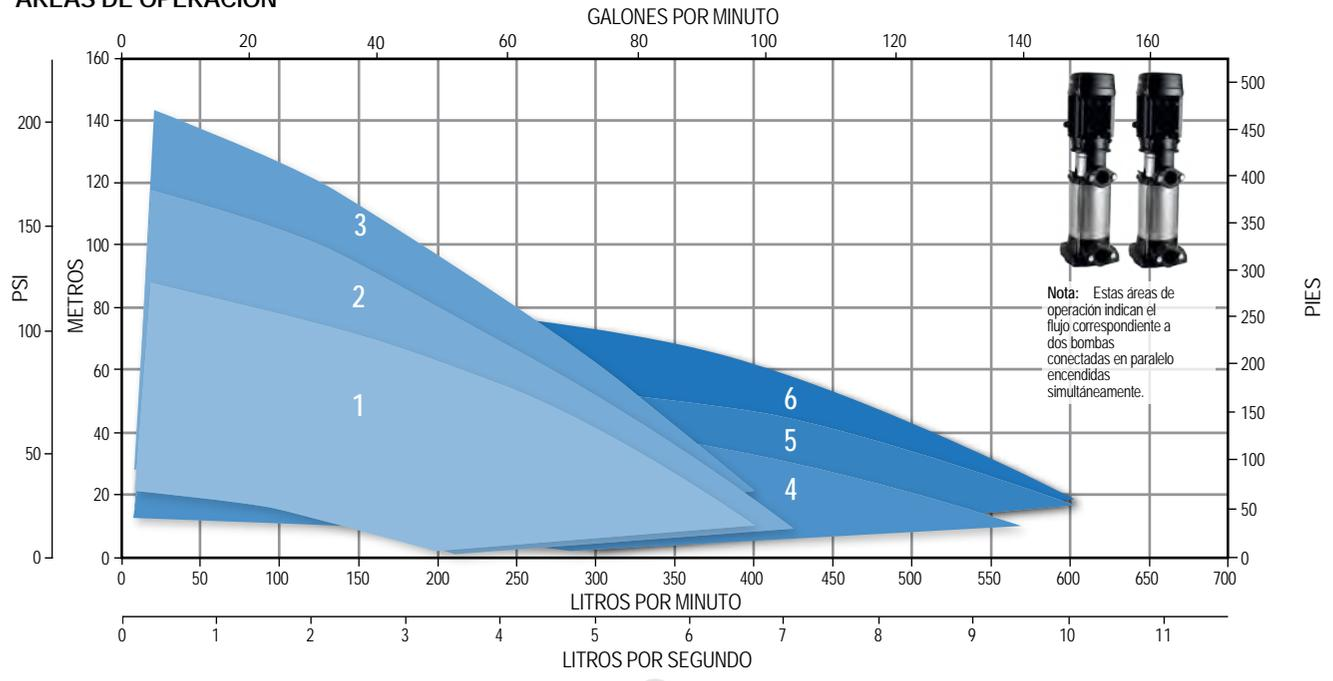
Nota: Estas áreas de operación indican el flujo correspondiente a dos bombas conectadas en paralelo encendidas simultáneamente.
