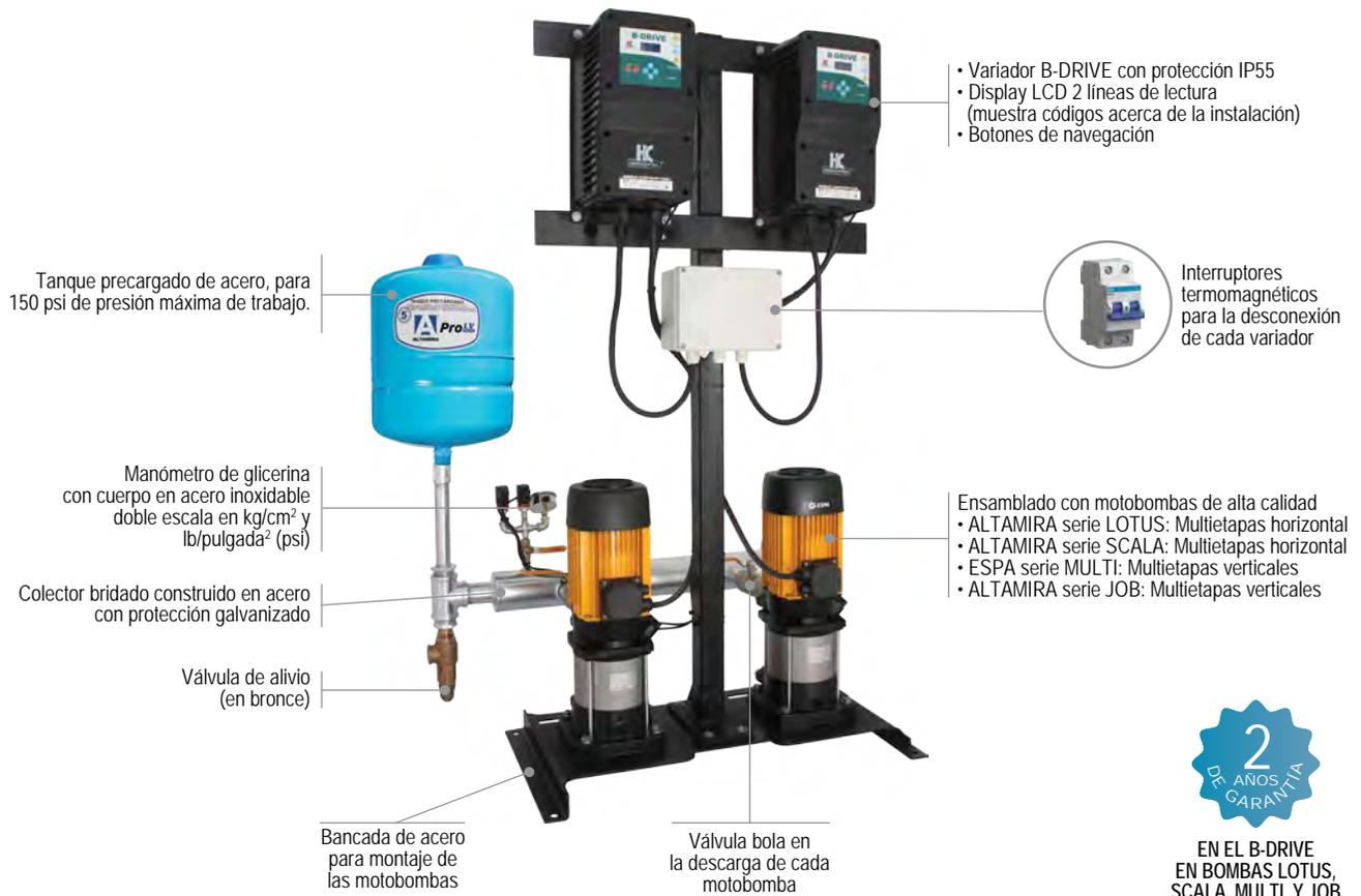
Tanque precargado de acero, para 150 psi de presión máxima de trabajo.
