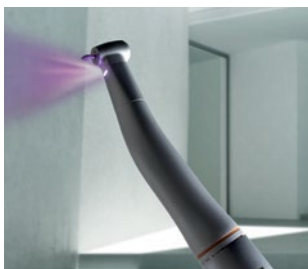
מיקרומוטור חשמלי חזק במיוחד עם טכנולוגיית FIT - אור מיוחד המאפשר זיהוי של שאריות קומפוזיט
