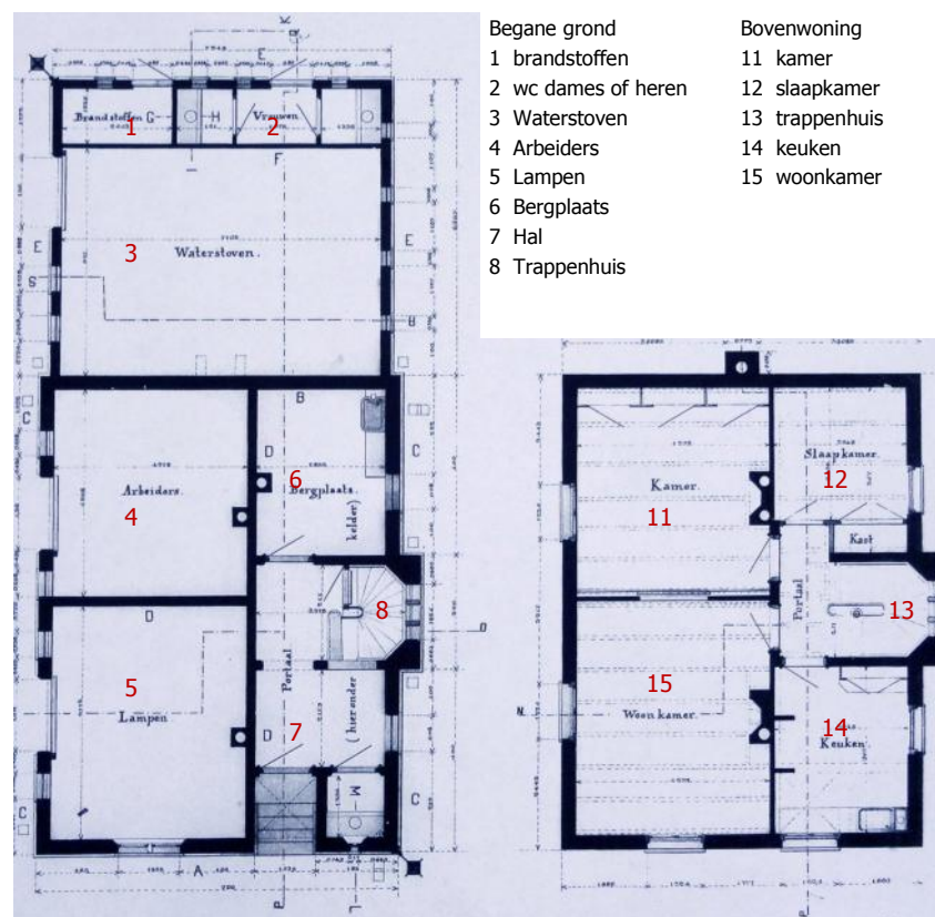
Afb. 2.9 Plattegrond met ruimte-indeling van de dienstgebouwen. Links de begane grond, rechts de bovenwoning. De bestekstekening is opgezet voor het verdwenen noordelijke dienstgebouw. Detail van bestekstekening op microfiche, HUA, arch.toeg. 959, inv.nr 3796.
