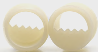
K409 - biała zawieszka do wciśnięcia w otwór o średnicy wierconej 13 mm; głębokość na 8 mm.
