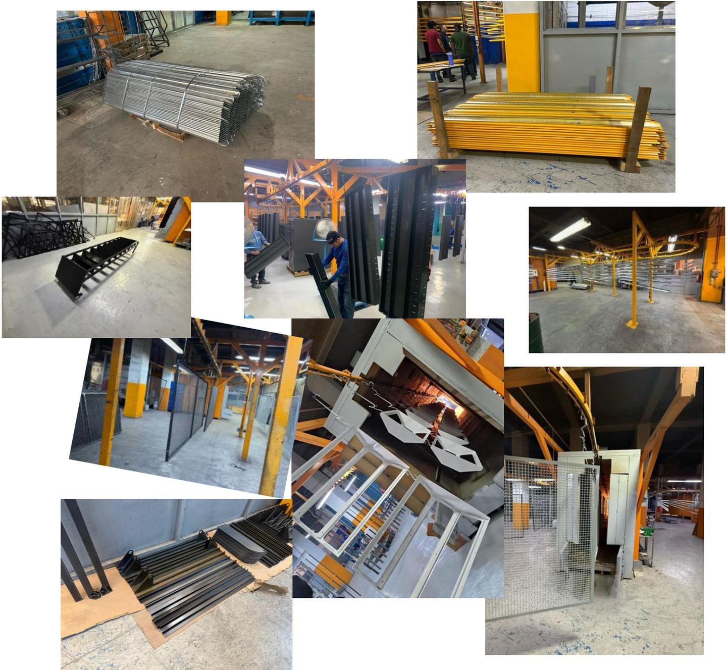
La pintura electrostática es una solución de acabado de alta calidad que garantiza una protección duradera y un acabado estéticamente superior para todo tipo de superficies metálicas. Este proceso utiliza cargas eléctricas para aplicar la pintura sobre las piezas, lo que asegura una distribución uniforme y una excelente adherencia, incluso en las áreas más difíciles de alcanzar.
