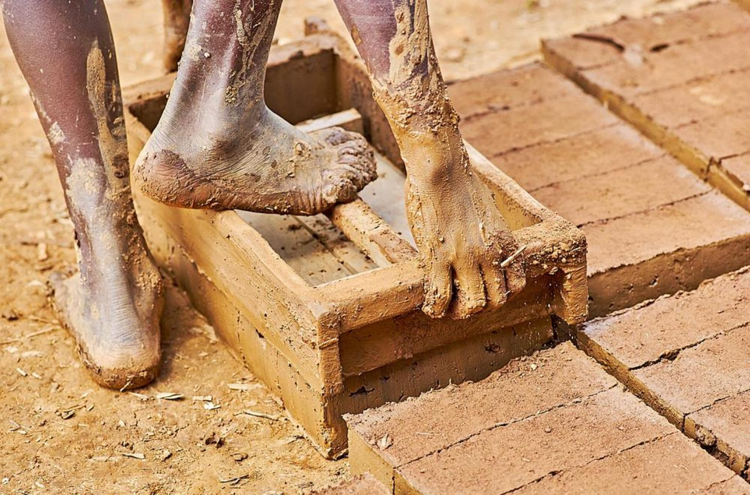
**D'un geste délicat, un briquetier extrait des briques fraîchement formées d'un moule en bois. Ces briques, qui n'ont pas encore été cuites pour assurer leur solidité, doivent être manipulées avec soin pour conserver leur forme avant d'entrer dans le four pour durcir.**
