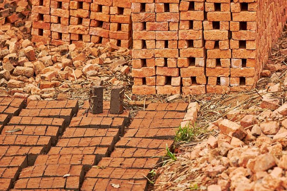
La scène illustre deux étapes de la vie d'une brique. Au premier plan, des briques rectangulaires séchées au soleil se prélassent, achevant le processus de séchage avant d'entrer dans le four pour la cuisson. À proximité, une pile de briques cuites méticuleusement empilées attend d'être vendue.
