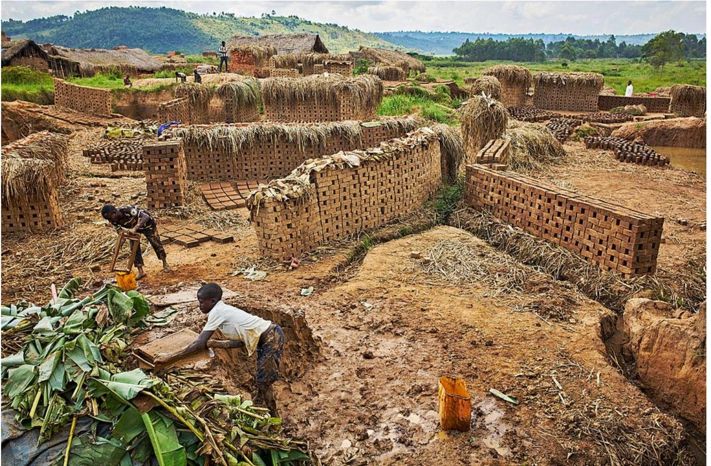
**Cette image montre le cœur du processus de fabrication des briques. Des ouvriers, adultes et enfants, travaillent ensemble pour façonner l'argile informe en briques rectangulaires . Des cadres robustes en bois dur servent de moules et des mains expertes façonnent le mélange pour garantir une taille et une forme uniformes.**
