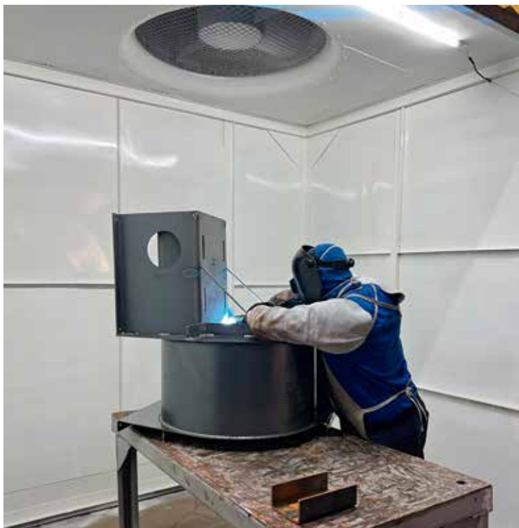
Ventilação localizada em ambiente industrial (Divulgação: Projelmec)
