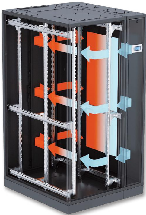
Geschlossener Kreislauf - Kühlung mittels des Seitenwärmetauschers
