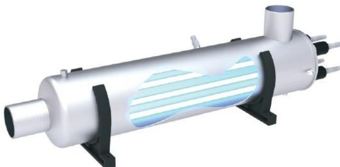
La gamme UV a été conçue pour la désinfection et la déchloramination de l'eau des piscines collectives et semi-collectives pour un débit allant jusqu'à 67 m<sup>3</sup>/h. Grâce à ses lampes basse pression, les chloramines présentes dans l'eau, responsables des irritations oculaires et cutanées, sont complètement détruites.
