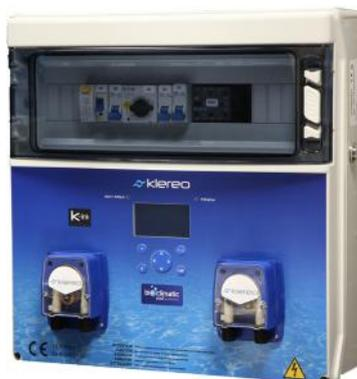
Le dosage du désinfectant est régulé par la sonde température d'eau dans le cas de l'oxygène actif, et par sonde Redox (incluse dans le kit Klereoo Kompact Master) pour les versions Chlore liquide, Brome et Electrolyse au sel.
