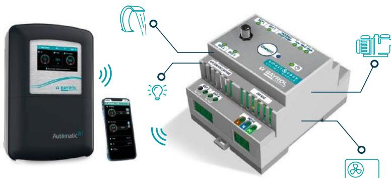
Les équipements commandés sont directement branchés et contrôlés par les relais du Smart&Easy Control Module. Un contacteur de puissance peut être utilisé dans le cas d'utilisation avec des équipements dont la consommation électrique est élevée (par exemple, pompe de filtration). La connexion sans fil avec Automatic SALT permet une installation simple et adaptable à tous types de locaux techniques.
