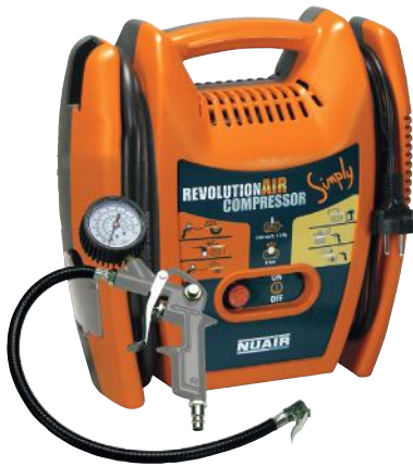
COMPRESOR 391189 HOBBY SIMPLY. 1,5 HP 180 L/m, presión máxima 8 bar, doble enrollador 3 m, manguera, pistola de inflado y 3 boquillas. 111'36 + IVA = 134'75
