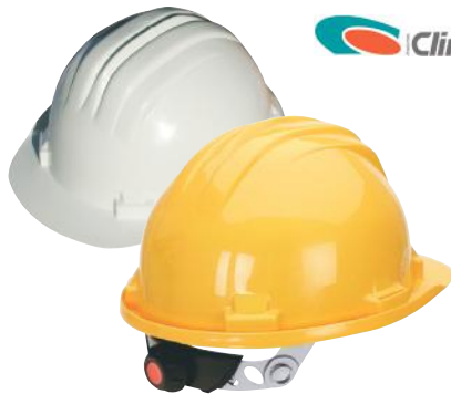
CASCO CON RUEDA Arnés ajustable. Banda antisudor. Ranura universal de 30 mm. Protección eléctrica: Hasta 1000V en AC y 1500V en DCI. Peso 322 gr. Blanco. 583756 Amarillo. 583758 4'50 + IVA = 5'45
