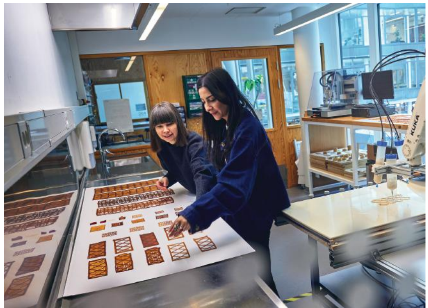
Det nytvecklade materialet består av bakjäst, cellulosa-fibrer från trä, alginat från alger, glycerol från växter, samt vatten. Tillsammans bildar ingredienserna en sorts hydrogel – ett mjukt, geléliknande och formbart material – som kan 3D-printas. Fotograf: Chalmers tekniska högskola | Henrik Sandsjö
