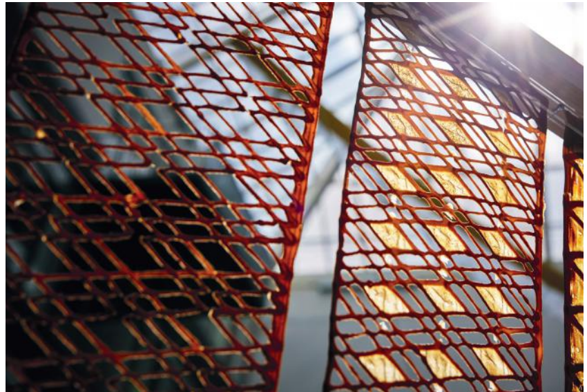
Ett nytt och helt förnybart material av en aningen oväntad ingrediens: jäst. Materialet 3D-printas och skräddarsys för att kunna användas i arkitektur- och inredningsdetaljer som idag tillverkas av exempelvis gips, plast eller syntetiska textilier. Fotograf: Chalmers tekniska högskola | Henrik Sandsjö
