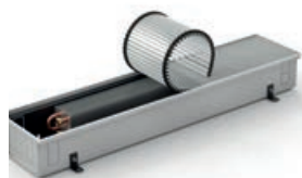
KORAFLEX OPTIMAL FKO podlahový konvektor ECONOMIC s přirozenou konvencí základní provedení, černě lakovaná pozinkovaná ocelová vana výměník tepla bez povrchové úpravy 1800/150/320 (délka/hloubka/šířka)
