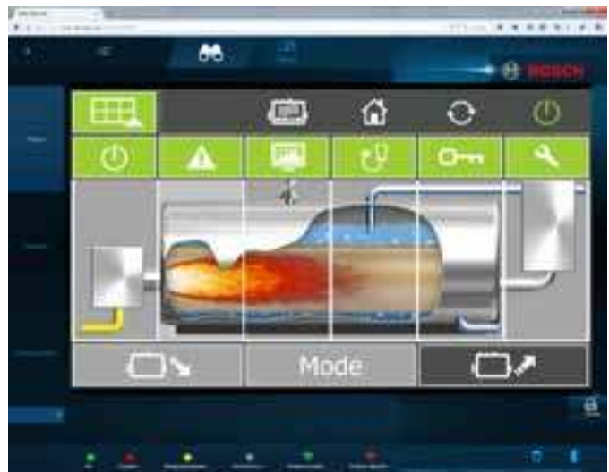
Acceso Remoto al control de la caldera
