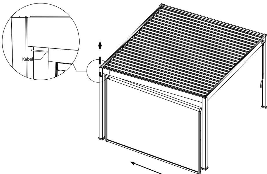
Führen Sie das Kabel durch das Loch, nehmen Sie das Kabel und ziehen Sie es straff, um ein Verheddern zu vermeiden.
