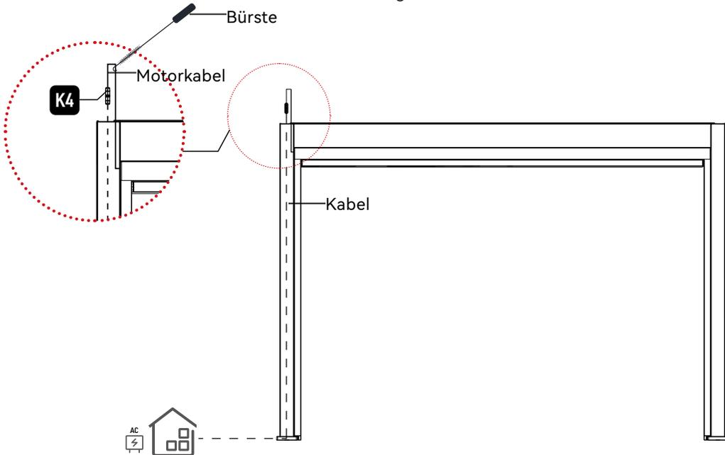
1. Führen Sie die beiden Kabel nach der Verbindung in den Pfosten ein.
