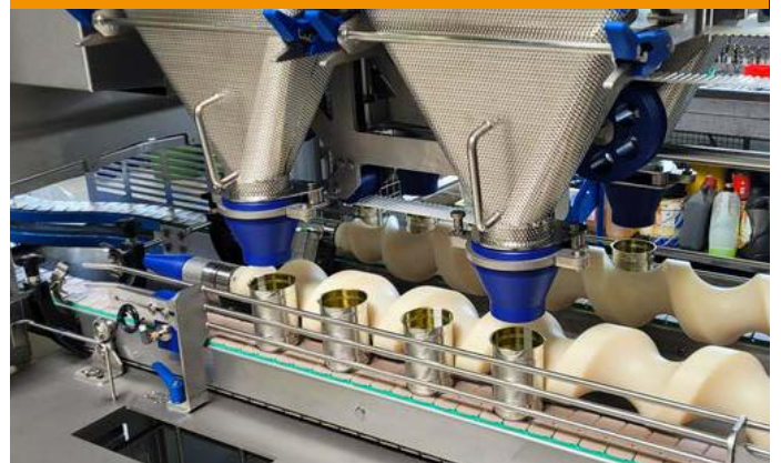
S5000 : Remplissage continu en ligne
