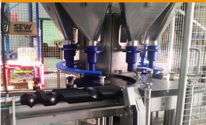
S4000 : Carrousel de remplissage
