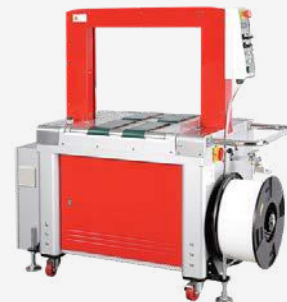
Cercleuse full-auto (intégrable dans une ligne d'emballage)
