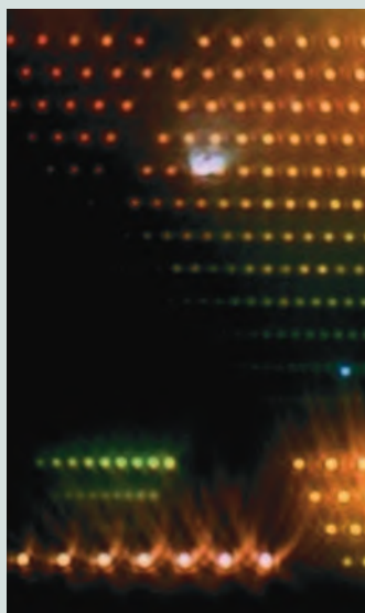
Nanoantena bat mikroskopioz ikusita. Koloreek transmisio-maiztasun desberdinak erakusten dituzte. ARG.: LTI.
