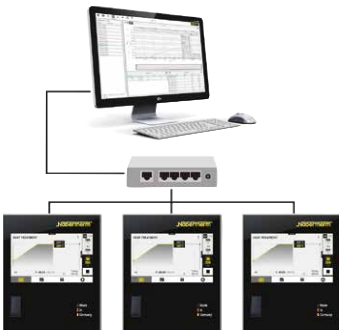
Exemple de montage avec 3 fours
