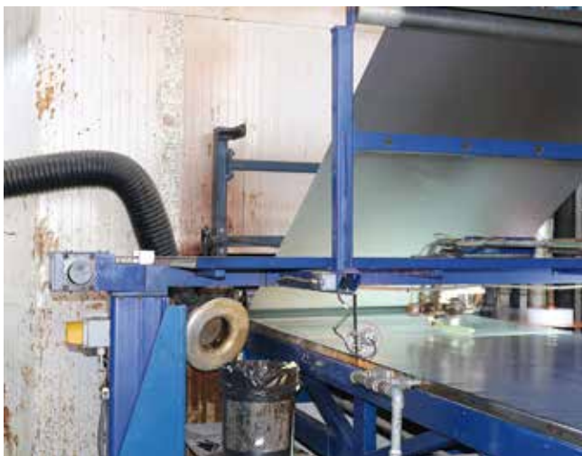
Aplicação do composto de PU
