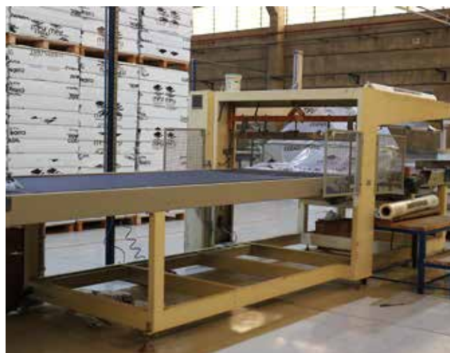
Embalagem mecanizada dos painéis de MPU
