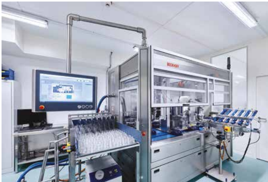
XPlanar steigert die Flexibilität der Abfüll- und Verschlussanlage von Glanzer cosmetic engineering und Pro Pharma Automation.
