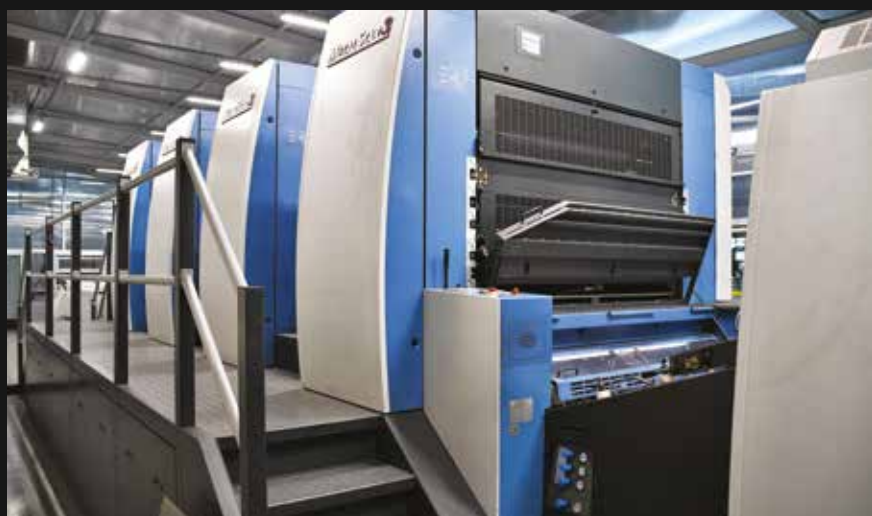
Metal Star 3 verarbeitet ein breites Spektrum an Blechformaten und gewährleistet damit eine hohe Produktionsflexibilität. Die UV-LED-Technologie mit Vierfarbdruck sorgt für hohe Qualität und verkürzte Produktionszeiten.
