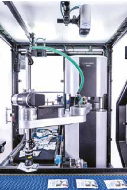
Mit dem tog.519 präsentiert Schubert seinen KI-gestützten, schnellen Pick-and-Place-Roboter
