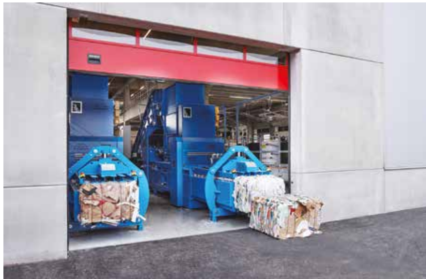
Für den langjährigen Kunden Cleanaway GmbH wird auf Schnelligkeit gesetzt. Für den Entsorgungsdienstleister wurden innerhalb weniger Wochen sechs vollautomatische Kanalballenpressen der Serie APK inklusive Fördertechnik an verschiedenen Standorten in Betrieb genommen. Zwei der Anlagen sind in Maria Saal im Einsatz.
