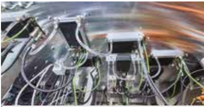
Blick unter das Maschinengestell: Durch die Wasserkühlung der Aluminium-Grundplatte werden die Temperaturvorgaben für die abzufüllenden Kosmetikprodukte eingehalten.
