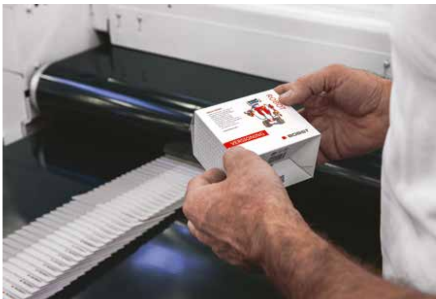
Nachdem der Stanzprozess den Zuschnitten ihre Form gegeben hat, erweckt der Falt-Klebe-Prozess die Verpackungen gewissermaßen zum Leben.
