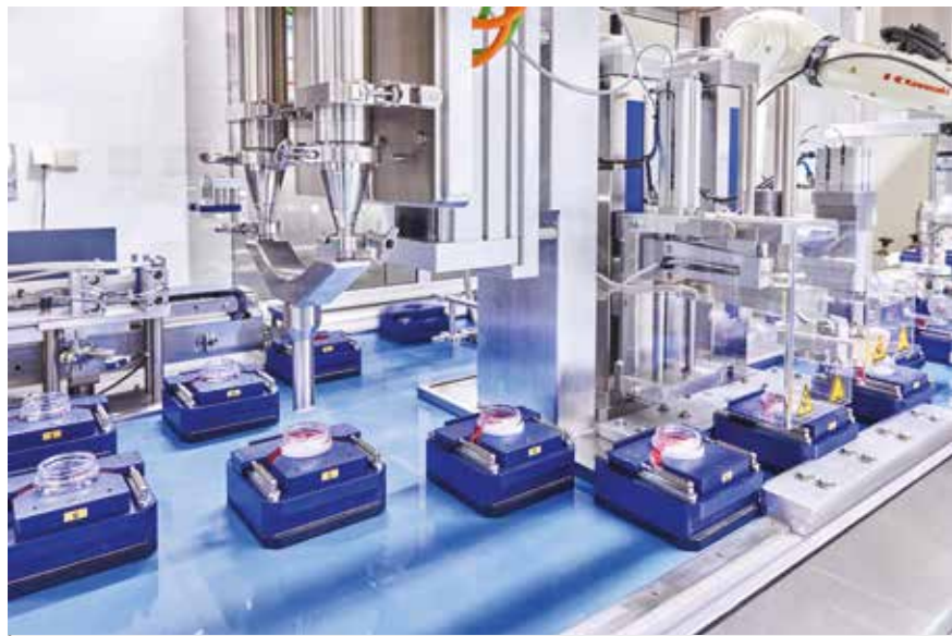
Trackmanagement und Kollisionsvermeidung von TwinCAT 3 XPlanar stellen sicher, dass die XPlanar-Mover auf der kleinen Fläche keine „Unfälle“ verursachen und die Prozessstationen mit hoher Präzision anfahren.
