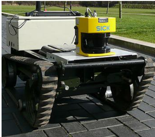
Figura 5. Sensor LiDAR marca SICK montado en un robot de orugas.
