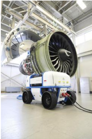
Lavage de moteur 360 Foam, réduit les émissions et améliore l'efficacité de sortie (Source: General Electric)
