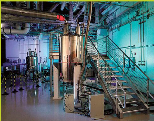
Erresonantzia magnetiko nuklearreko ohiko espektrometro bat. Makinaren zati handiena, metalezko zilindro handia, eremu magnetiko indartsua sortzen duen elektroimana da. Zati hori kenduta, espektrometroa gailu eramangarri bat izango litzateke. ARG.: PACIFIC NORTHWEST NATIONAL LABORATORY.
