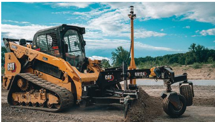
Plataforma de control de nivelación Trimble Earthworks en una hoja niveladora Cat GB124 (Fotografía cortesía de Buck Brothers)
