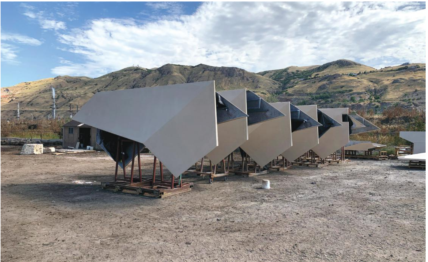
Fig. 5: Conjunto de paneles GFRC para el Walton Center fabricados por Unlimited Designs (cortesía de Unlimited Designs)
