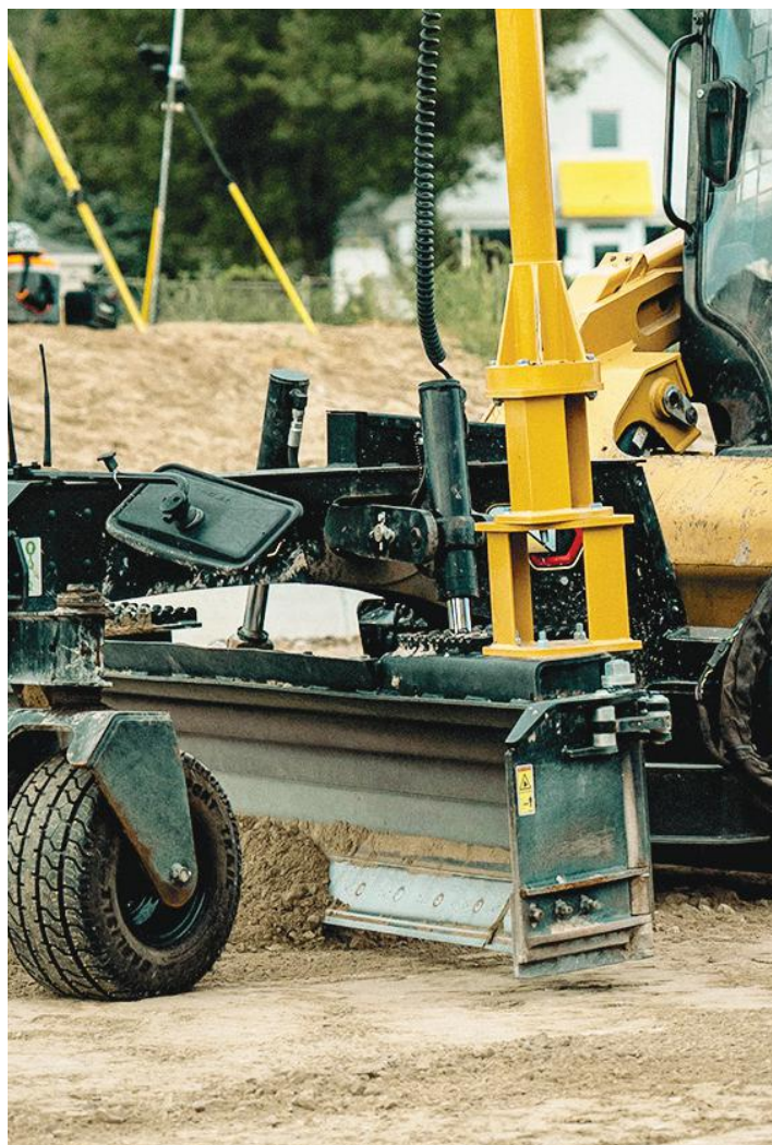
El objetivo de la Máquina Trimble MT900 rastreado por una Estación Total Universal Trimble SPS930 (Fotografía cortesía de Buck Brothers)
